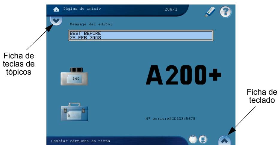
Panel frontal de la pantalla táctil (pantalla de inicio)
